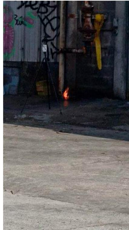
Dispositif mis en place pour tester les batteries quart de lune au choc
